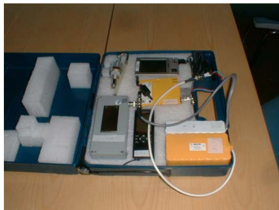
Figur 1. Udstyr til måling af personlig eksponering
