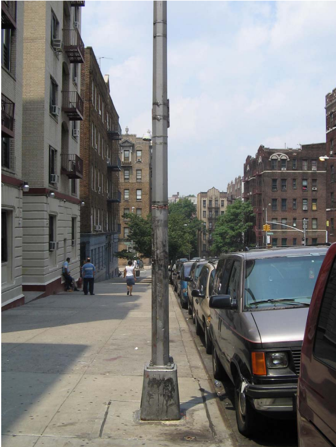
Figur 4. Eksempel på et af de mange målesteder, hvor der måles samtidigt for at bestemme den geografiske variation af luftforureningen (kun NO x , NO 2 ). Passivt måleudstyr er monteret på lygtepælen i ca. 4 m højde. Disse målinger indgår som en del af mange målinger, som anvendes i valideringen af AirGIS systemets evne til at beregne luftforureningsniveauet.
