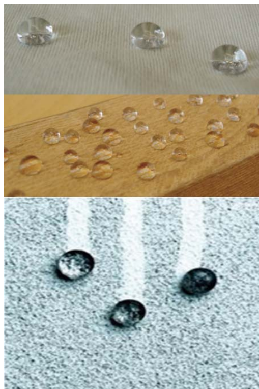
Figur 1. Vanddråber på bomuld, træ og beton behandlet med et nanofilmprodukt.
